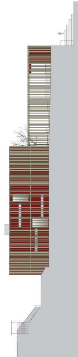
Nordwestfassade mit Darstellung des Ballschutzes in Form von Staketen
